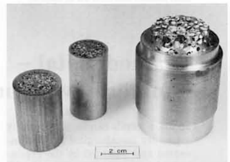
Bild 6: Mit Aluminiumschaum ausgeschäumte Aluminiumrohre verschiedener Durchmesser und Wanddicken
