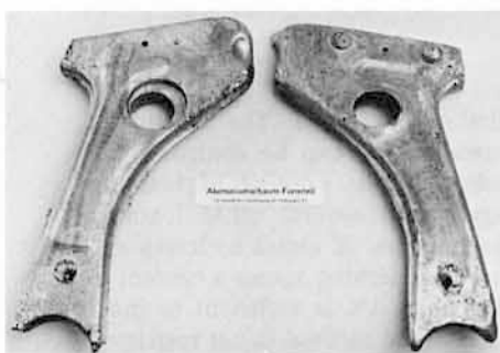
Bild 5: Formteile aus Aluminiumschaum der Dichte 0,5 \text{ g/cm}^3 ; Länge der Teile ca. 350 \text{ mm} (Foto: Volkswagen)
