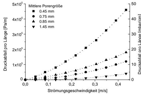
**Abbildung 5:** Durchströmungskurven einiger Aluminiumschäume. Aufgetragen ist der Druckabfall  $\Delta p$  bezogen auf die Probenlänge  $L$  gegen die Strömungsgeschwindigkeit  $v$ .
