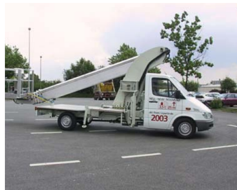
Abbildung 12: Hubarmhalter eines Kranwagens. Anwendungsidee basierend auf den Festigkeitseigenschaften und der Steifigkeit metallischer Schäume in Kombination mit einer erheblichen Gewichtsreduzierung [6]. (Fa. Teupen, Fa. ALM)
