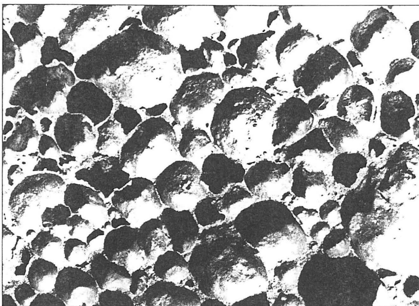
Bild 1 Schnitt durch einen Aluminiumschaum der Dichte 0,5 \text{ g/cm}^3
