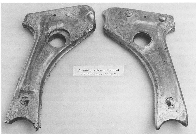
Bild 2: Formteil aus Aluminiumschaum (Dichte 0.5 g/cm 3 )
