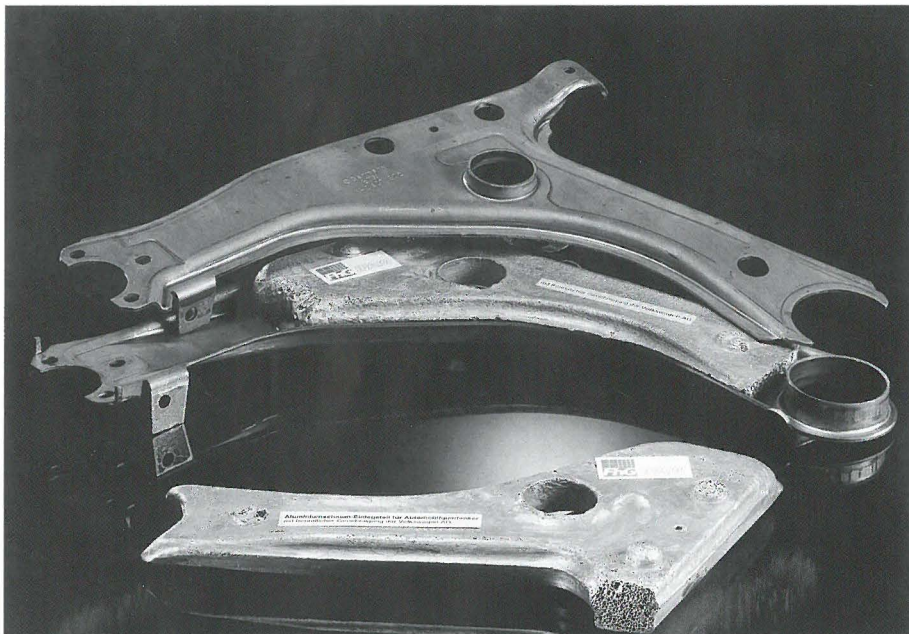
Bild 4: Formteile aus Aluminiumschaum der Dichte 0,5 \text{ g/cm}^3 . Länge der Teile 400 mm (Mit freundlicher Genehmigung der Volkswagen AG)
