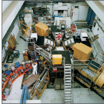
Bild 4: Zyklotron zur weiteren Beschleunigung von Ionen
